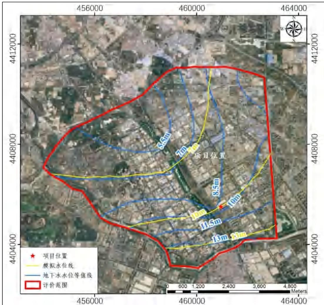
图 5.2-3 计算水位与实测水位（2021.3）拟合结果
