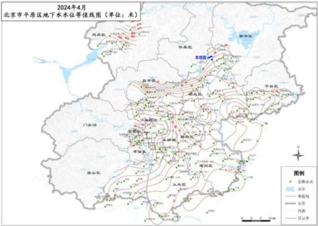
图 4.2-1 2024 年 4 月潜水等水位线图（枯水期）
