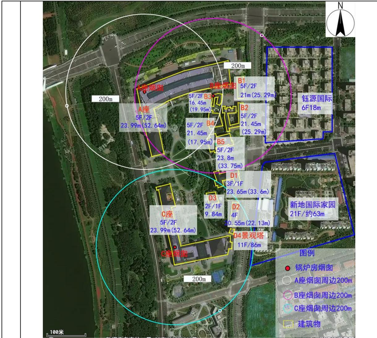
图 2-4 锅炉房烟囱周围半径 200m 范围内建筑物图、
