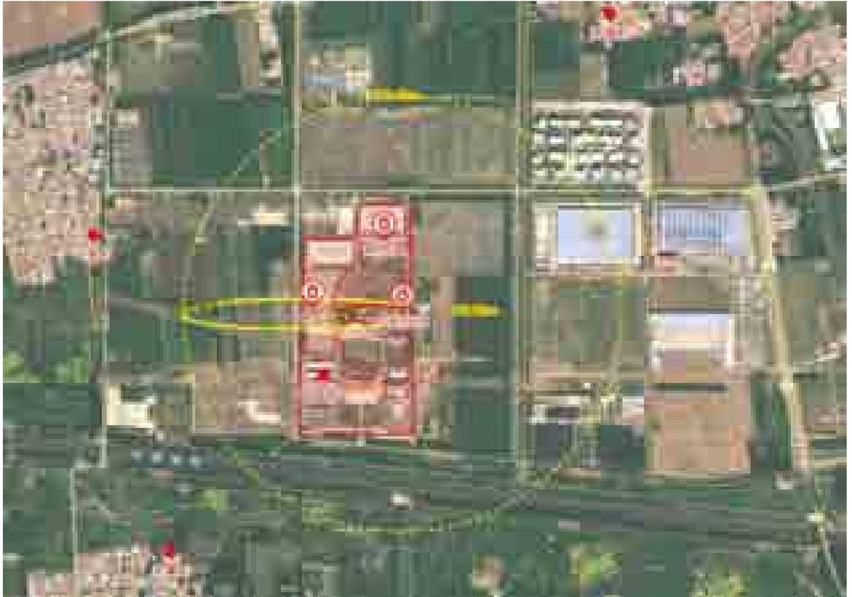
**图 6.8-4 最不利气象盐酸泄漏影响范围图 (SLAB)**
