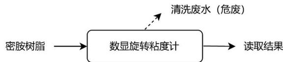
**图3.7-5 树脂黏度测试的工艺流程及产污环节**
